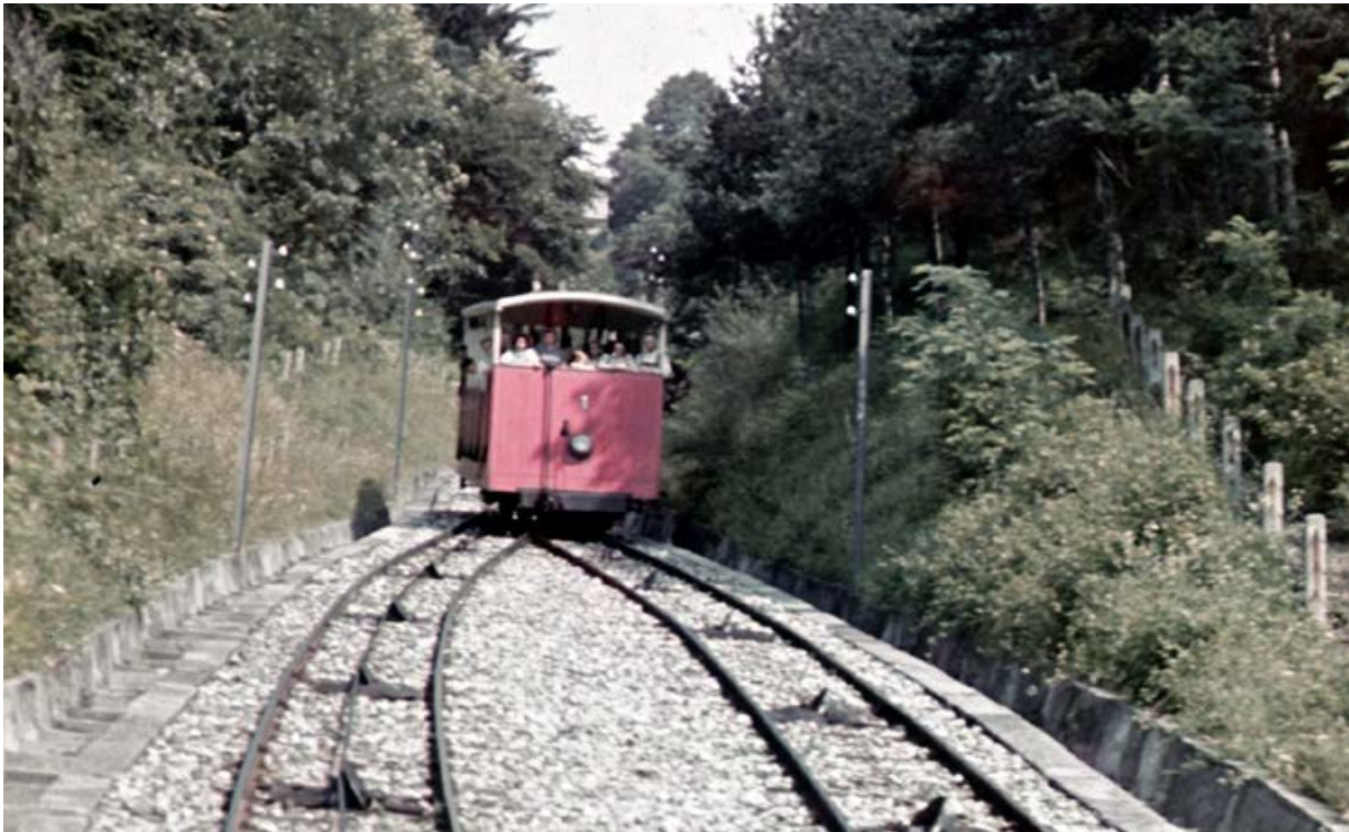
Eine Ausflugsfahrt bei schönem Wetter mit der alten Hungerburgbahn: Die beste Aussicht genoss man auf den offenen Plattformen am Ende der Wagen. Die Bahn wurde von Ingenieur Josef Riehl geplant und verkehrte ab 1906. Für die Strecke von 839 m und die Höhendifferenz von 287 m betrug die Fahrzeit damals 11 Minuten. (Foto: Privatarhiv Fam. Egger)
